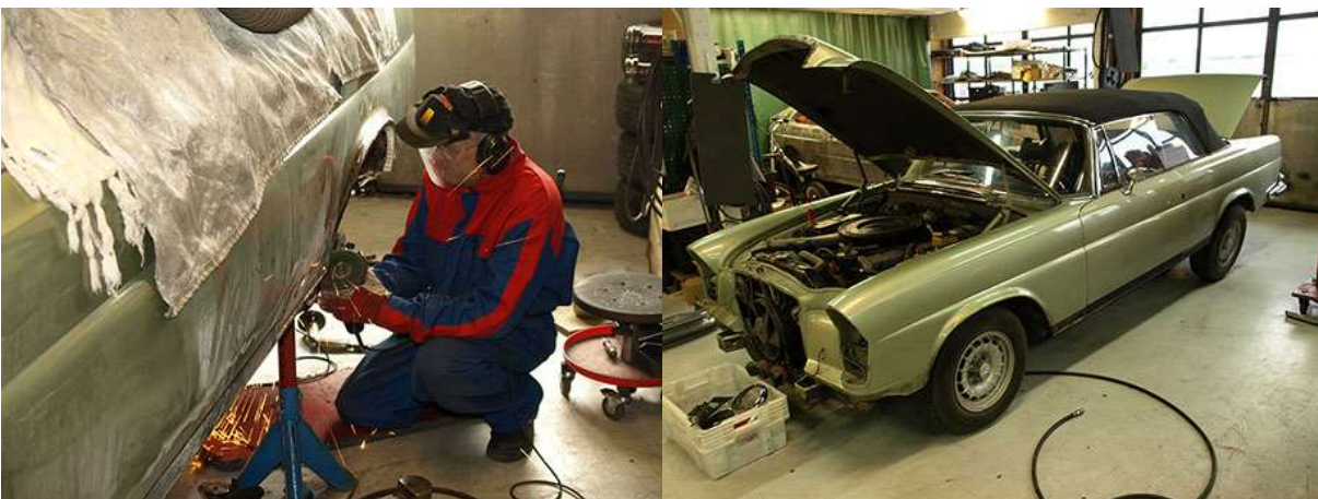
Lokasuojan ruosteaurion korjausta. Osittaisen entisöinnin laajuus rajoittui koriin, maalaukseen ja verhoiluun. Tekniikka kunnostettiin vain tarvittavilta osin.
