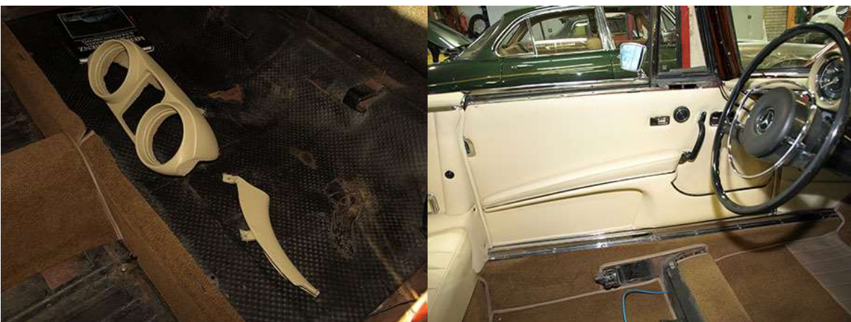
Kojelaudan ja mittariston osia pohjamaalattuna. Sisusta verhoiltiin uudelleen täysin alkuperäistä vastaavaksi.
