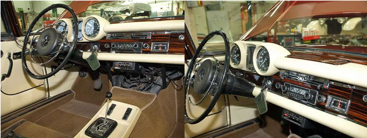
Sisusta verhoiltiin uudelleen täysin alkuperäistä vastaavaksi. Lisäksi sisustan puuosat uusittiin alkuperäistä vastaaviksi.
