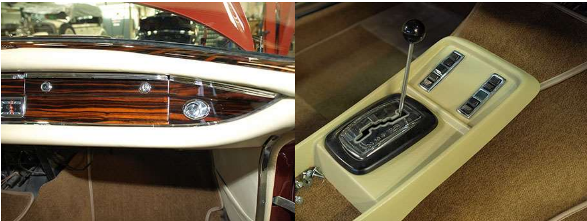
Sisustan puuosat uusittiin alkuperäistä vastaaviksi. Lattiamatot uusittiin kokonaan alkuperäistä vastaaviksi.
