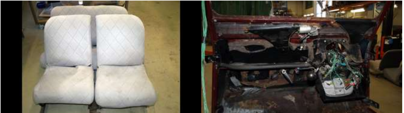
Auton penkit irrotettuna ennen kunnostusta. Kori purettiin täysin kaista laitteista perusteellisen tarkastuksen vuoksi.
