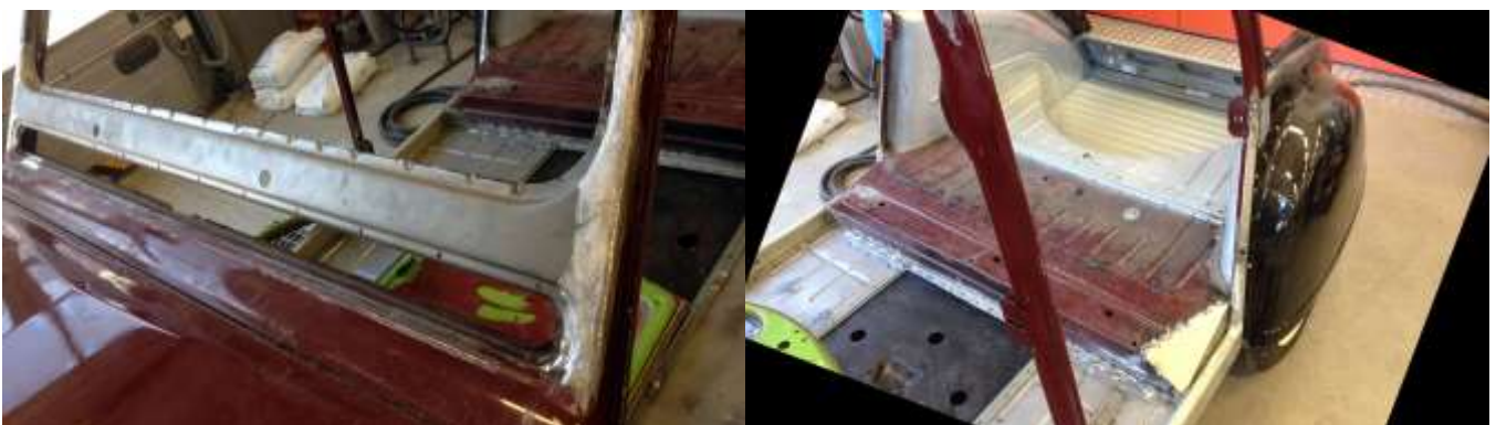
Tuulilasin alaosan palkki vaihdettiin terveeseen. Uutta lattiaa.
