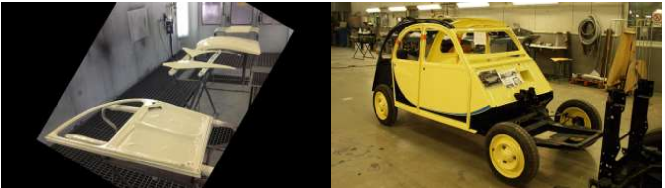
Ovet, luukut ja muut irto-osat maalattiin ympäriinsä, myös sisäpuolelta. Lopullinen väritys on kelta-musta Charleston rajauksin.
