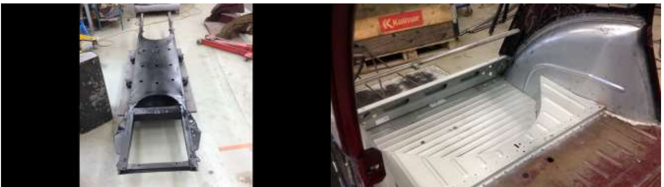
Kunnostettu runko. Korin takaosan uudet pellit.
