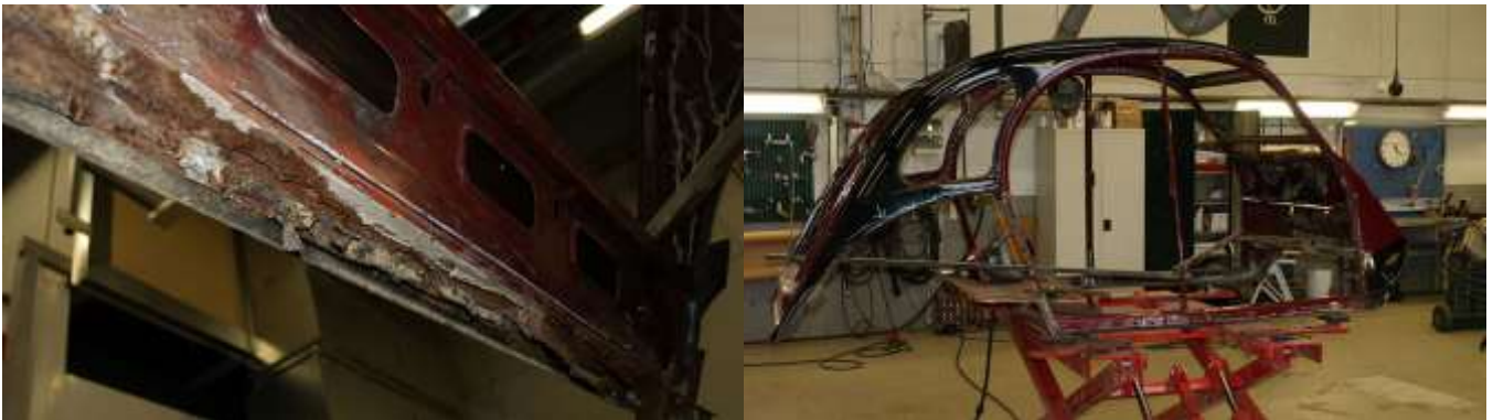
Ruostevaurioita paljastui ympäri autoa. Tyhjä kori purettuna korjausta varten.
