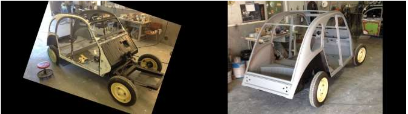
Auto maalaamossa pohjatyövaiheessa. Epoksi- ja hiontapohjamaali ruiskutettuna.
