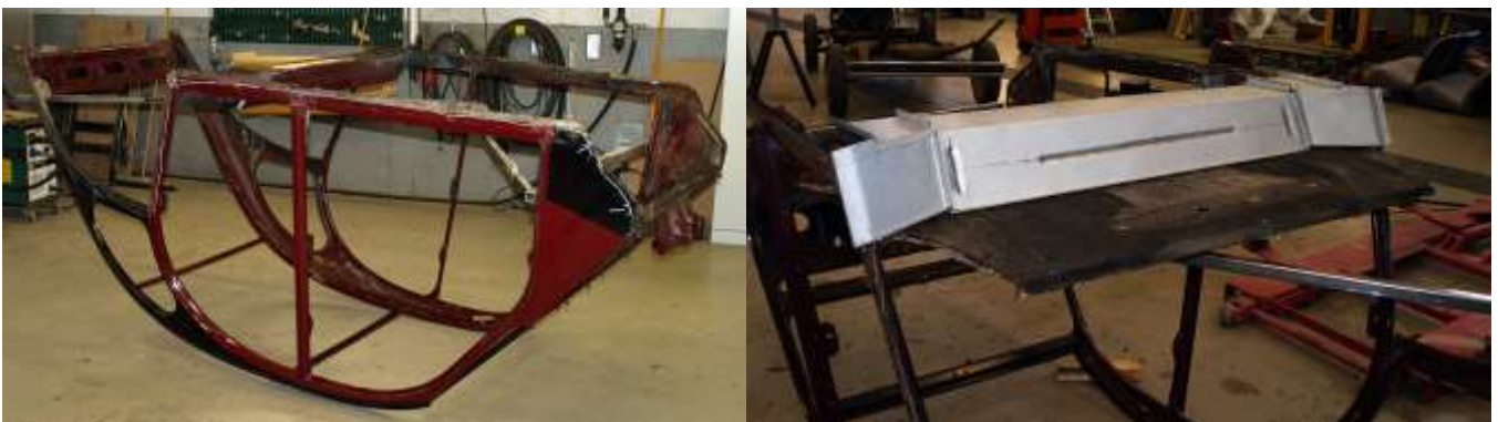
Tyhjä kori purettuna korjausta varten. Osa korjauspelleistä valmistettiin käsityönä täysin alkuperäisen mukaisiksi.
