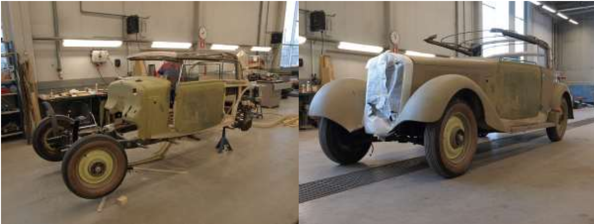
Puinen kori verhotaan pellillä. Pelti- ja puuosien sovittaminen on vaativaa käsityötä.
