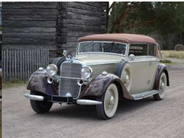
Katon pintakangas asennettuna vailla viimeisiä listoja. Loppukokoonpanoa.
