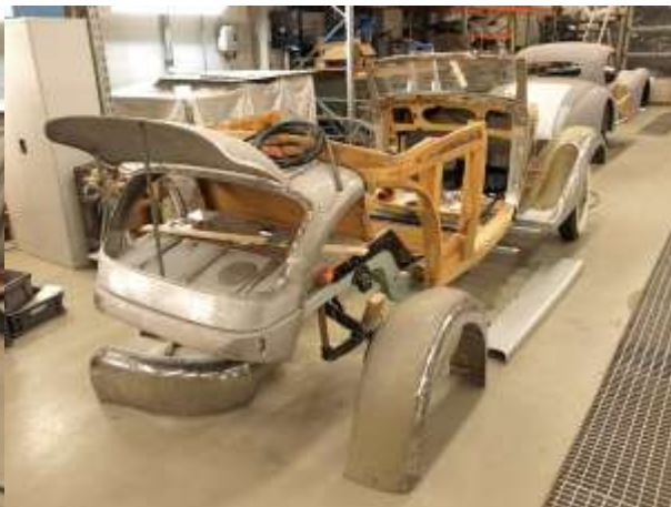
Kylkipeltien ja ovien sovitusta. Astinlautojen ja kylkipeltien sovitusta.
