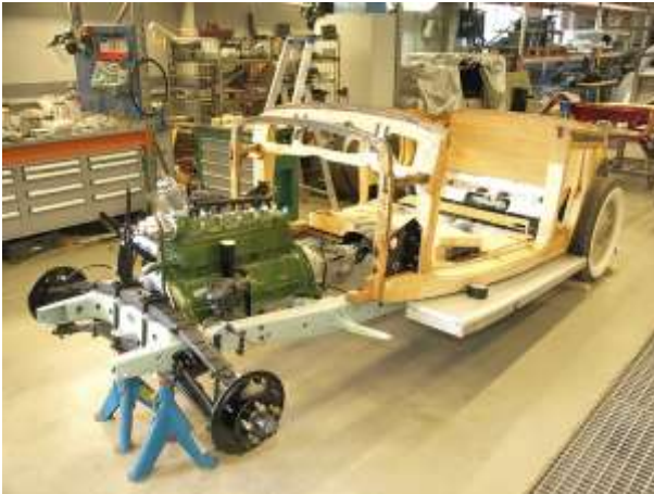
Kunnostettu moottori ja vaihteisto asennettuna takaisin autoon. Ensimmäiset maalatut korin osat asennettuna paikalleen.
