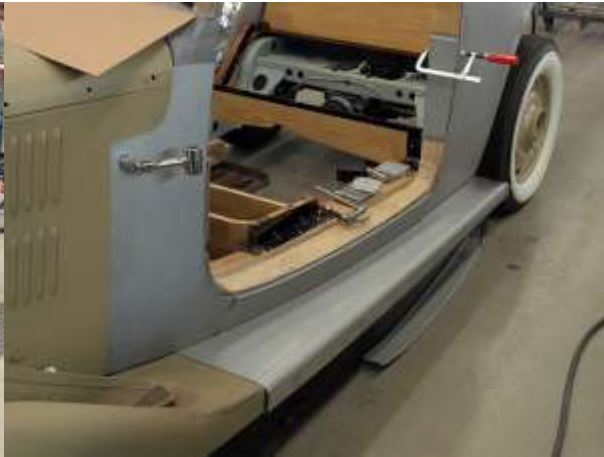
Kylkipeltien ja ovien sovitusta. Astinlautojen ja kylkipeltien sovitusta.
