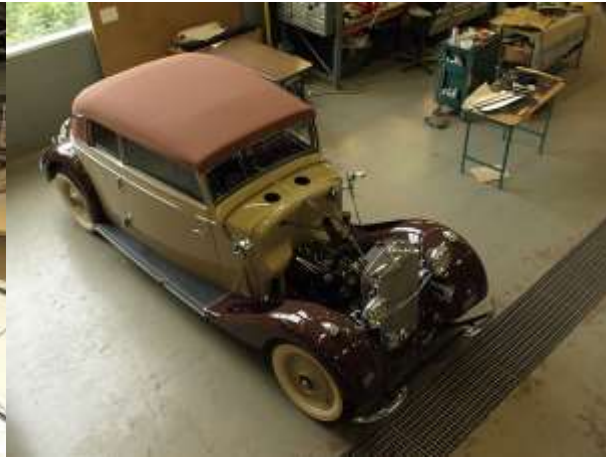
Katon pintakangas asennettuna vailla viimeisiä listoja. Loppukokoonpanoa.
