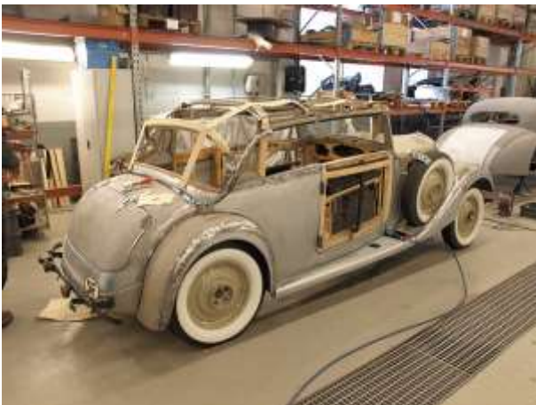
Kattomekanismin uudelleenrakennusta ja runkoa.
