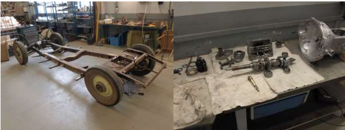
Auton runko purettuna. Vaihteisto purettiin ja kunnostettiin kokonaan.
