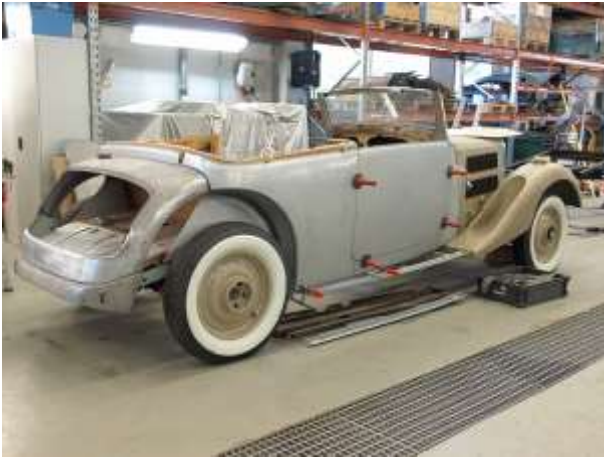
Kylkipeltien ja ovien sovitusta. Astinlautojen ja kylkipeltien sovitusta.
