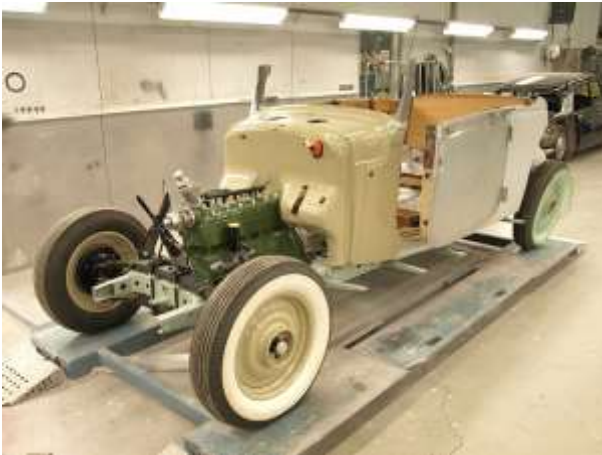
Auto maalaamossa. Kori maalattiin auton alkuperäisellä sävyllä.
