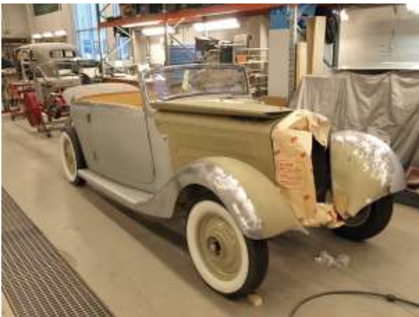
Peltiosien yhteensovittamista. Takalokasuojien korjausta.
