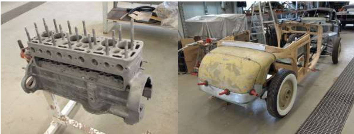
Moottori purettiin osiin ja puhdistettiin perinpohjaisesti. Takaosan peltien sovitus.
