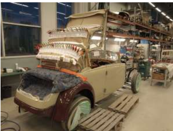
Katto valmistettiin kokonaan käsityönä. Lokasuojat maalattiin niin ikään alkuperäisellä sävyllä.
