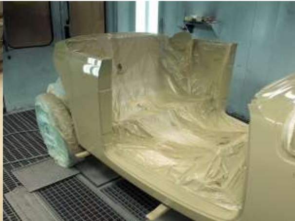
Auto maalaamossa. Kori maalattiin auton alkuperäisellä sävyllä.
