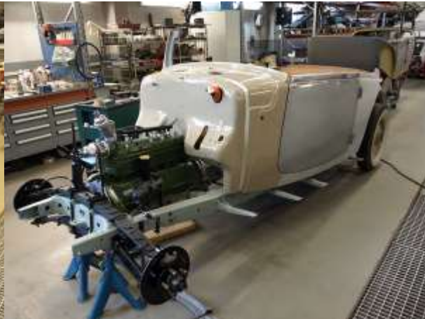
Kunnostettu moottori ja vaihteisto asennettuna takaisin autoon. Ensimmäiset maalatut korin osat asennettuna paikalleen.
