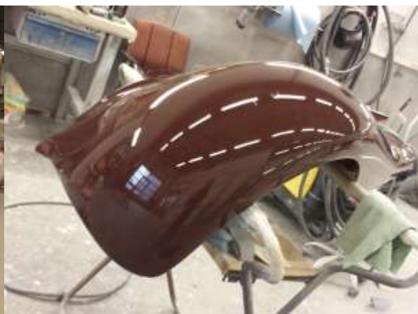
Katto valmistettiin kokonaan käsityönä. Lokasuojat maalattiin niin ikään alkuperäisellä sävyllä.
