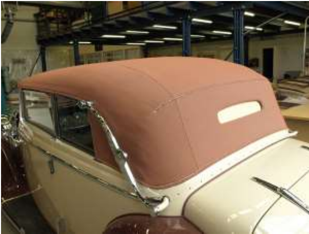
Katon pintakangas asennettuna vailla viimeisiä listoja. Loppukokoonpanoa.
