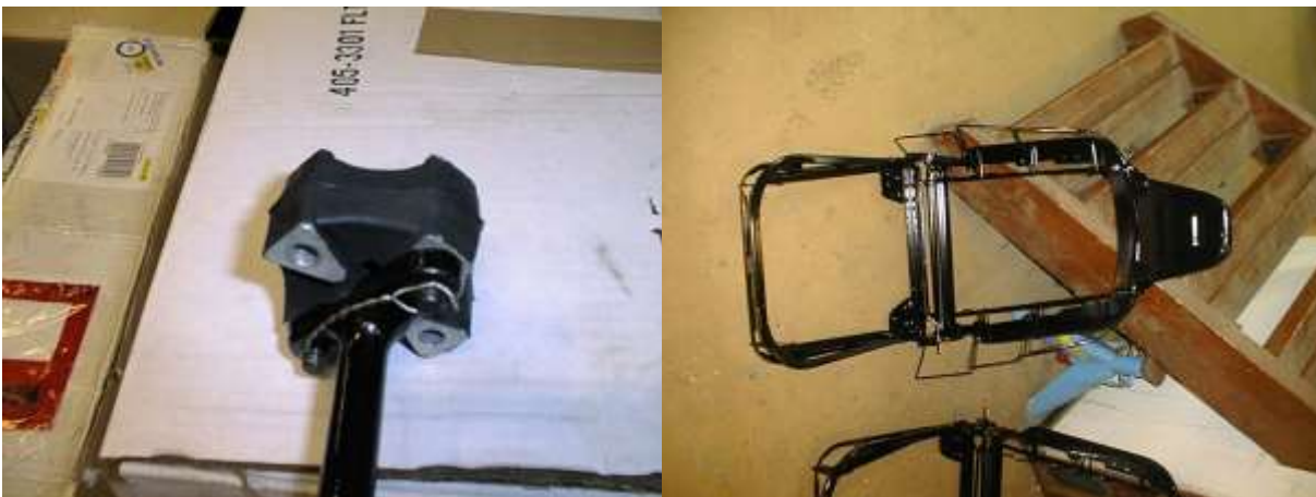
Kunnostettu ohjaukseli. Penkit purettiin, niiden rungot korjattiin ja maalattiin.
