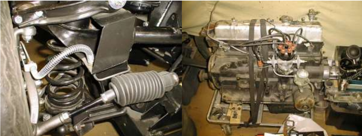
Kaikki ohjauslaitteiden kuluvat osat uusittiin. Moottori ennen kunnostusta.
