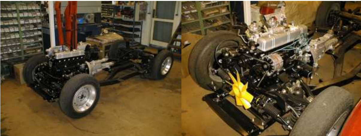
Moottori siistittiin alkuperäiskuntoiseksi ja asennettiin paikalleen. Vaihdelaatikko oli soodapesty, eikä sitä ole maalattu tai muulla tavoin käsitelty.
