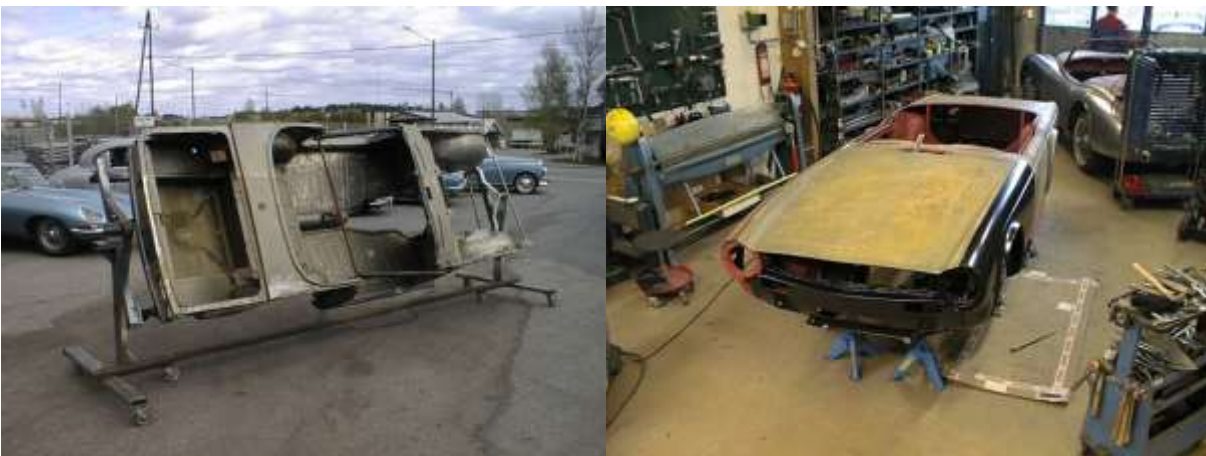
Korin tukena oli kunnostusvaiheessa väliaikainen tukikehikko. Etulokasuoja ja hiekkapelti uusittiin laadukkailla korjauspelleillä.
