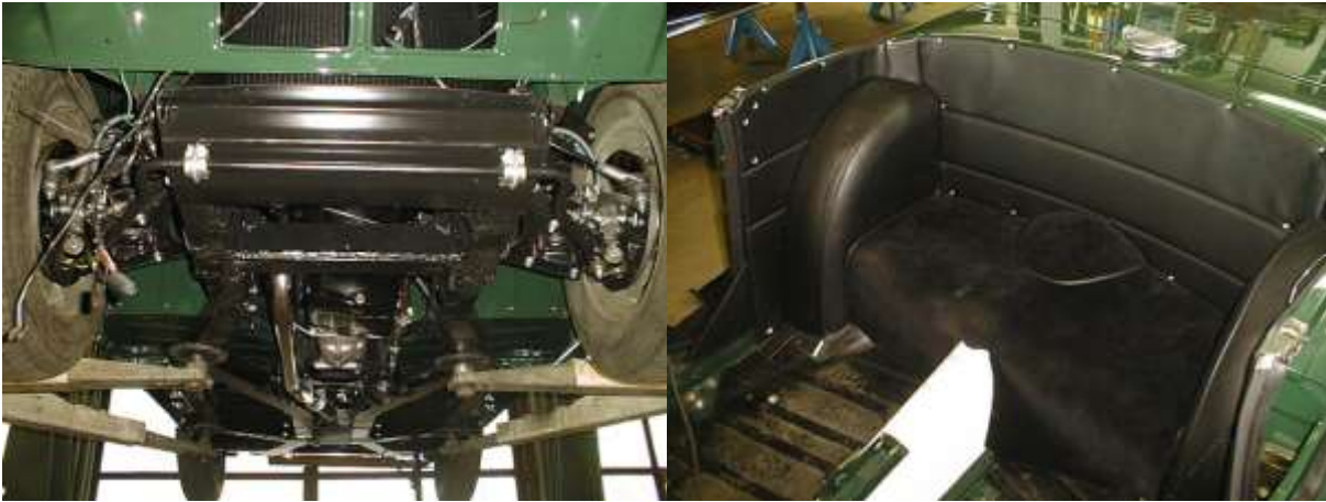
Kunnostettua alustaa. Sivuverhoilut ovat vinyyliä ja matot villaa. Etupenkit verhoiltiin nahalla.
