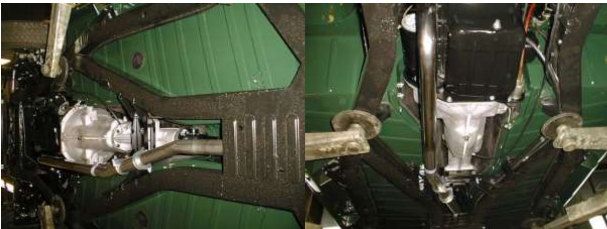
Kunnostettua alustaa. Pakoputki on ruostumatonta terästä.
