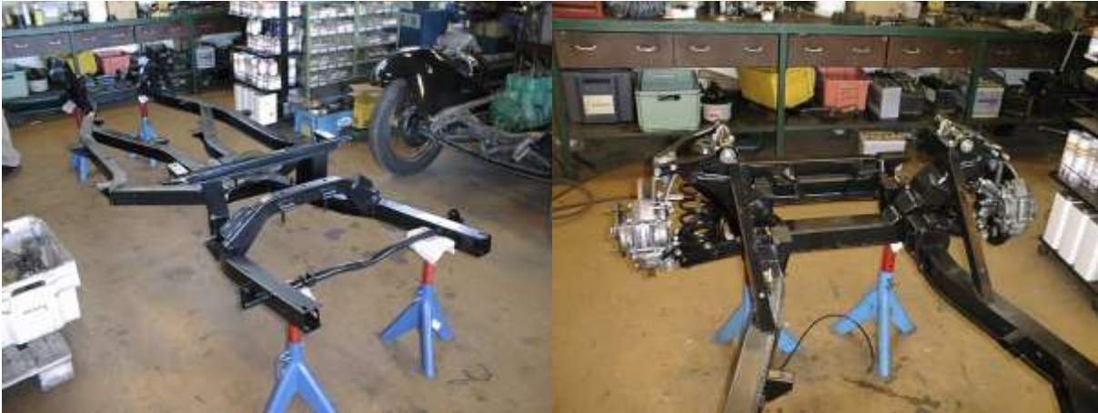
Auton runko oikaistiin. Etujousituksen, jarrujen ja ohjauslaitteiden kokoonpanoa.
