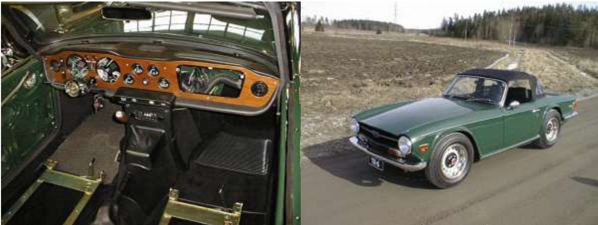
Kojelauta viilutettiin uudelleen kirsikkapuuviilulla. Kaikki mittarit kunnostettiin uutta vastaavaan kuntoon. Myös alkuperäinen British Leyland -radio kunnostettiin. Kaikki lasit vaihdettiin uusiin.
