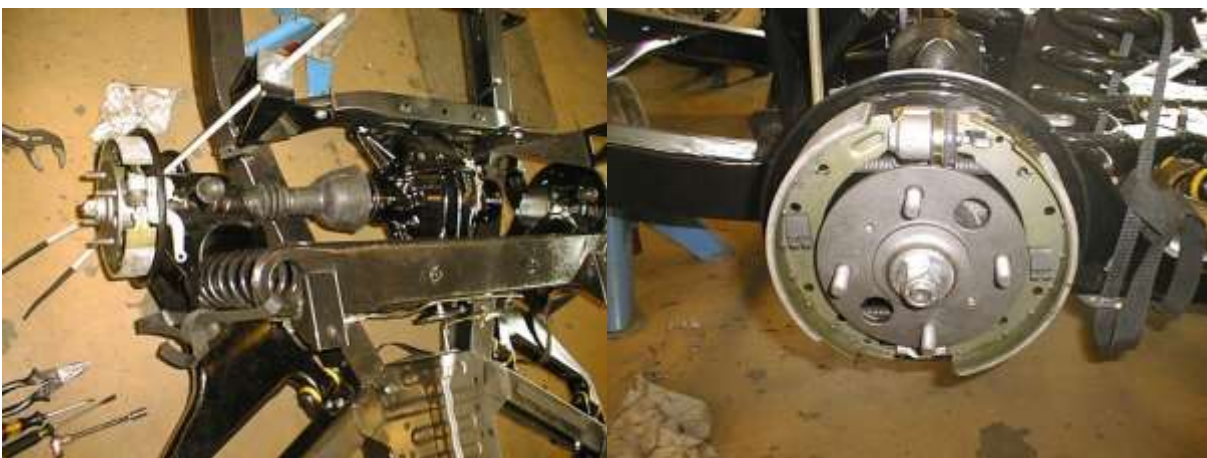
Auton ajettavuutta parannettiin vaihtamalla kaikki alustan puslat polyuretaanisiin. Takajarrujen kokoonpanoa uusin kulutusosin.
