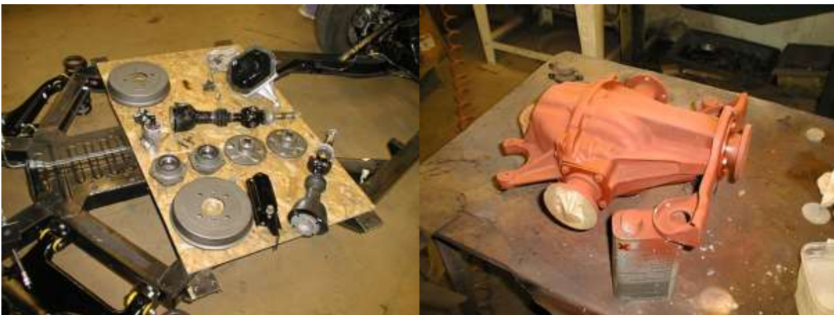
Kokoonpanon yhteydessä kaikki kuluvat osat uusittiin. Perä kunnostettuna ja pohjamaalattuna.
