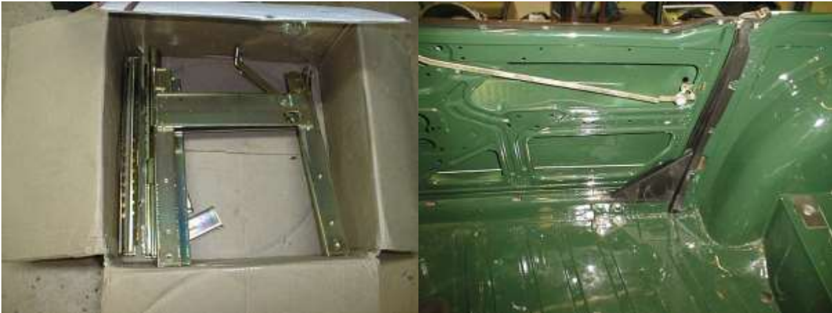
Penkkien liukukiskot uusittiin kokonaan. Kaikki osat on maalattu irrallaan, eikä missään työvaiheessa ole oikaistu.
