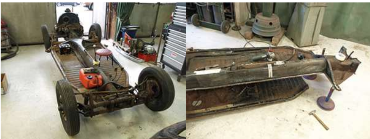
Ohjaukselia ja rattia vaille koeajokunnossa. Ruostuneet lattiapalat uusittiin.
