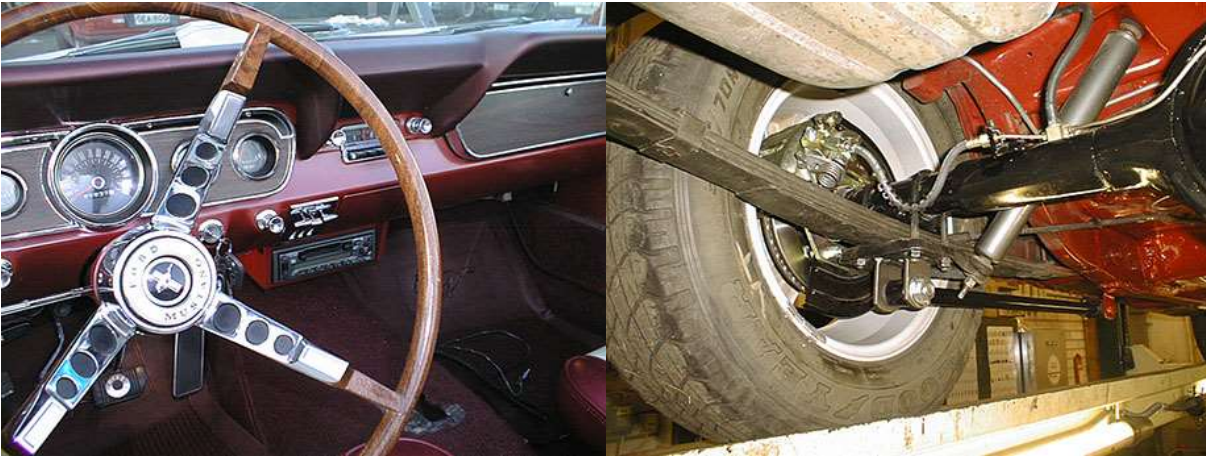
Auton sisusta on jo koottu valmiiksi. Perän lisätuennaksi asennettiin ns. Shelby-tuet, jotka estävät perän kiertymisen kiihdytyksessä.
