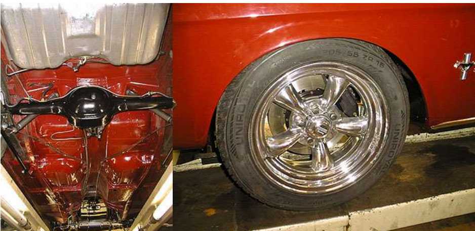
Alusta maalattiin suureksi osaksi uudelleen mittavien vahvistusten ja jäykistysten takia. Vanteiksi valittiin American Racing Torgue Thrust II. Rengaskoko on edessä 205/55-16 ja takana 215/55-16. Jousituksen lopullinen korkeus säädettiin niin, että renkaat istuivat mahdollisimman kauniisti lokasuojien kaariin.
