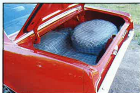
Auton tasopisteet säilyvät takaluukkuun kurkistetessaakin: Tällaista ruudullista "kernimuovia" näissä uutena käytettiin.
