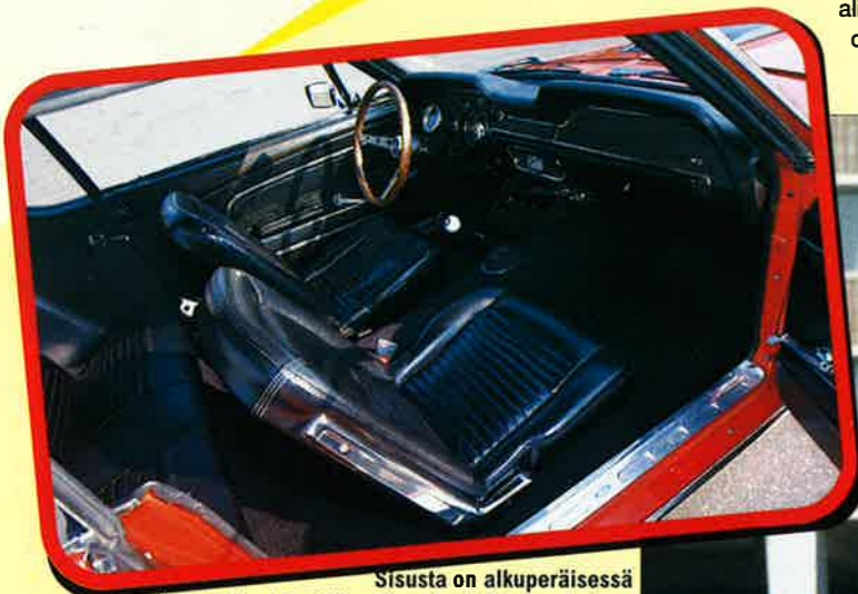
Sisusta on alkuperäisessä kuosissaan. Penkit eivät paljon sivuttaistukea tarjoa, mutta tyyliin sopivia rallimalleja ei Kimmo ole löytänyt. Ratti vaihdettiin Grantin 15-tuumaiseen puukehämalliin. Alkuperäisestä ohuesta ja muovisesta kehästä ote lipsui herkästi.
