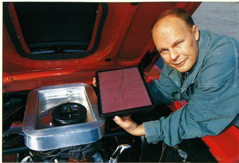
Konepeltiin tiivistävä alumiininen kotelo pitää sisällään ison, hyvin hengittävän K&N ilmansuodattimen ja virtausta kaasuttimeen parantavan K&N stubstack-supppelin.
