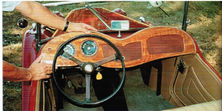
Arthur Glaze valmisti autoomme mallin mukaan alkuperäismallisen ja -tyyppisen puisen kojetaulun. Nyt kaivattaisiin enää valkopohjaisia mitareita, kojelaudan keskellä olevaa vipu- ja vedinsarjaa ja oikealle hankalokeroa. MG:n peilit, lasinpyyhkimet yms. ovat ensiasennustyyppiä.
